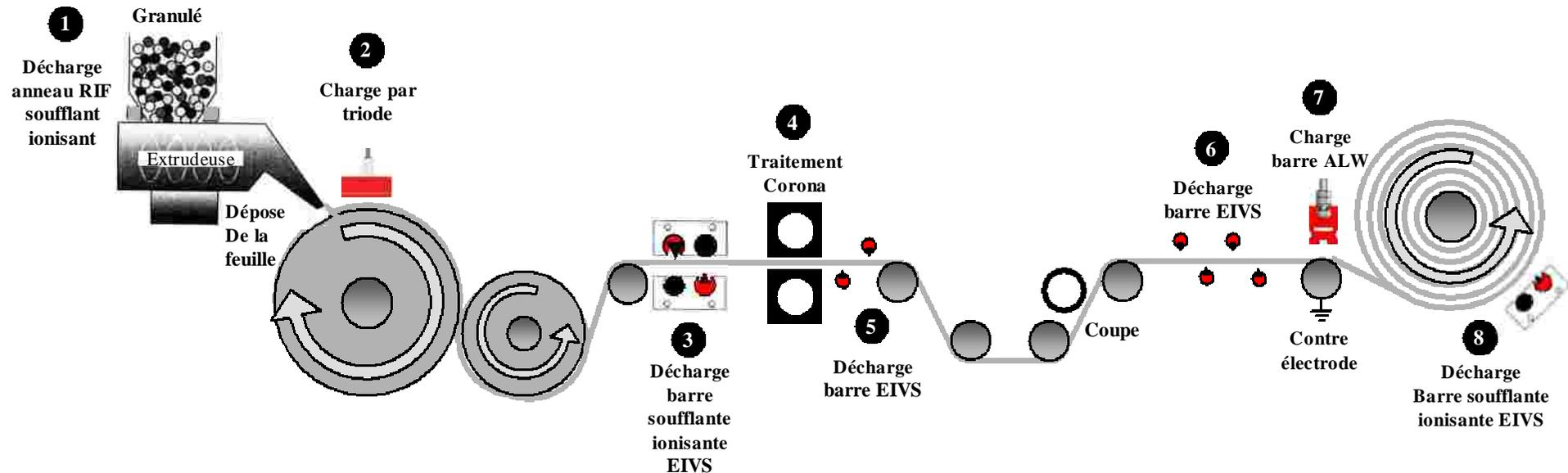
La fabrication de film nécessite les systèmes d'ionisation suivant :
